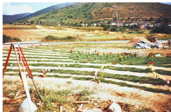
Figura 4. Ramas de analema de horas en punto (período verano/otoño). Se colocan flores artificiales a intervalos de 5 días (1, 5, 10, 15, 20 y 25) cada mes, su color cambia en función del mes. Vista desde el Norte.
