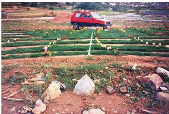
Figura 5. Imagen muy similar a la anterior, vista desde el Norte. En primer término el punto de emplazamiento del teodolito (estación topográfica); para el replanteo de las diferentes fechas/horas. Al hacer el replanteo desde el Norte fue preciso hacer la correspondiente transformación de coordenadas, que inicialmente se calcularon para ser replanteadas desde la vertical del punto que produciría la sombra. Este punto aún no estaba cuando se tomaron estas fotos situado en el terreno a los 3 metros de altura. Estaba, eso sí, en el suelo creo recordar (ver figura 2).
