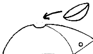
GOMA LACA AL 20 %. ACEITE Y VACIADO CON COLA DE CARPINTERO FUNDIDA AL BAÑO MARIA
